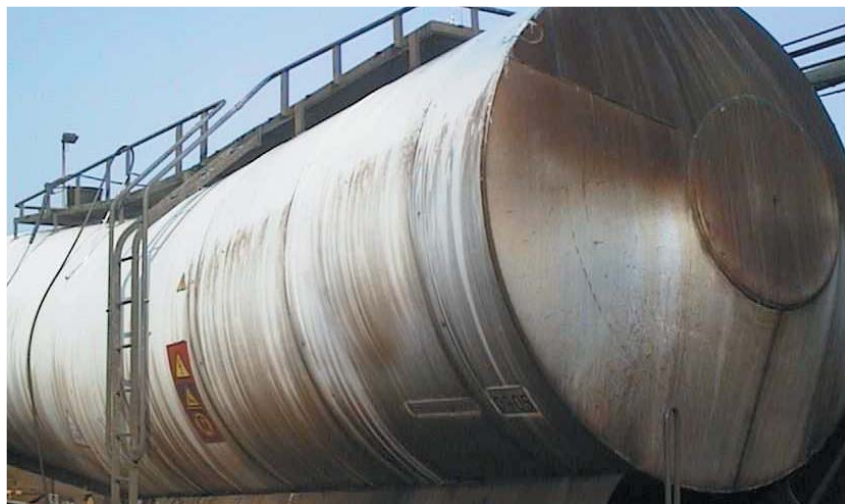
Bild eines Kesselwagen nach mehrjährigem Einsatz vor der Aussenreinigung.
