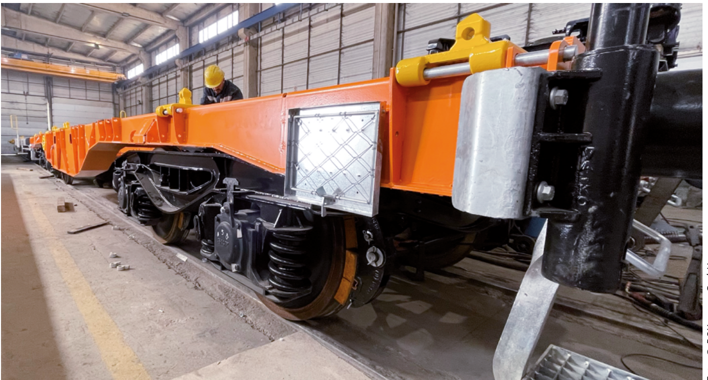
Zwölf Monate nach Projektstart stand der fertige Prototyp des 40-Fuss-Tragwagens auf dem Gleis.
