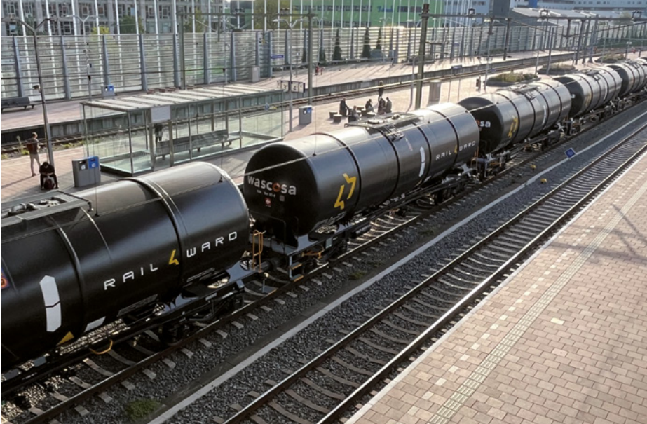
Leicht, zuverlässig und mit einer perfekten Kubik ausgestattet: Die von Rail4ward gemieteten schwarzen Kesselwagen 88m 3 , Zacns von Wascosa. (Quelle: Rail4ward)
